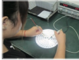
半田付け後の点灯検査は必ず行います。
