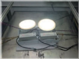
振動の強い場所にて正常起動テスト。
