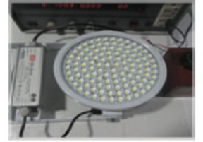
組立後 100% 点灯チェック。
