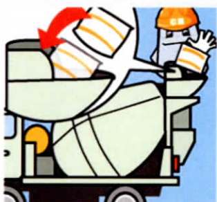
現場到着生コン車の投入口から袋ごと投入
