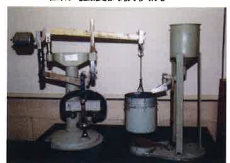
曲げ強度試験状況
