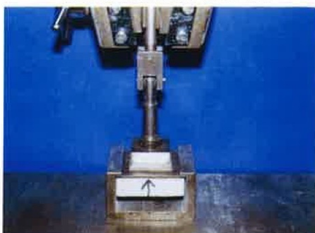
接着引張強度試験状況
