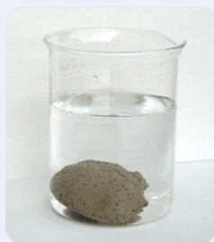
水中モルタル
