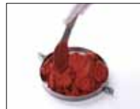
テク/カラーを型枠に入れる
