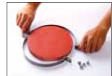
硬化後、型枠を取り外す
